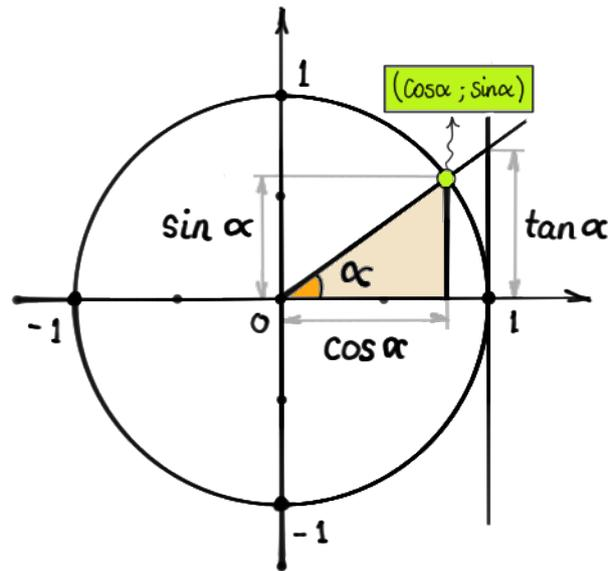
Ainsi, lorsqu'on relève les coordonnées du point dans le repère orthonormé (système d'axes à angle droit), apparaît naturellement un triangle rectangle. La longueur de l'hypoténuse de ce dernier vaut 1. La **longueur de la cathète horizontale** est définie comme le **cos(alpha)** et la **longueur de la cathète verticale** est définie comme le **sin(alpha)**.
