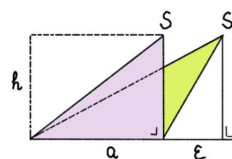
Dans ce qui suit la profondeur ( $b$ ) n'est pas visible sur cette vue latérale. Pour le volume du solide ayant pour sommet  $S$  on a  $V = \frac{a \cdot b \cdot h}{3}$ , et pour le volume du solide ayant pour sommet  $S'$  on a  $V' = V_1 - V_2$ , où  $V_1 = \frac{(a + \epsilon) \cdot b \cdot h}{3}$  et  $V_2 = \frac{\epsilon \cdot b \cdot h}{3}$ . Mais  $V = V'$ . En effet :
