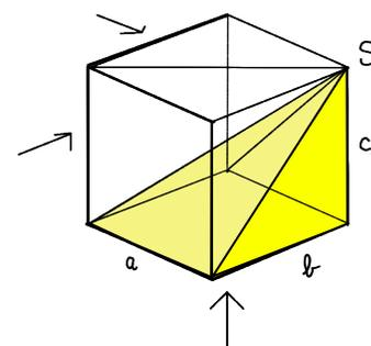
Mais calculons le volume du parallélépipède rectangle ci-dessus. On a que le volume total est la somme des volumes des trois pyramides de sommet  $S$ , donc  $V = V_1 + V_2 + V_3$  :
